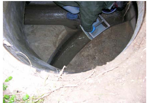
Messung des Fremdwasser mit Schale
